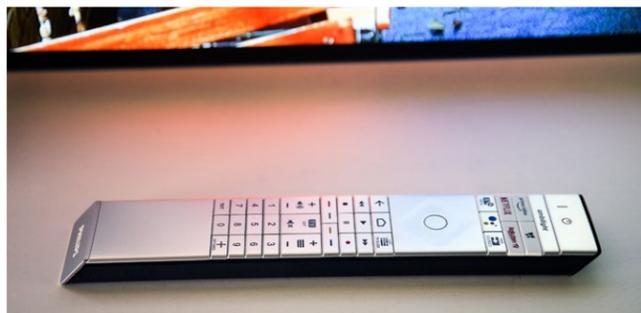
Die Fernbedienung von Philips liegt gut in der Hand. Die beleuchtete Tastatur gestattet auch in dunklen Räumlichkeiten eine sichere Navigation durch das On-Screen-Menü.
