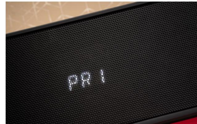
Ist eines der abgelegten Presets angewählt, wird dieses für wenige Sekunden im Display ablesbar.
