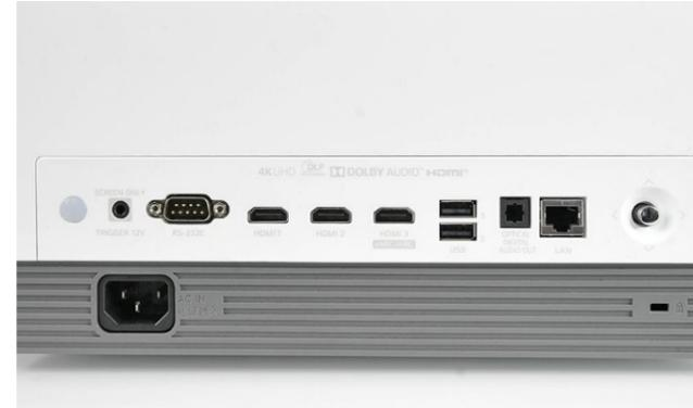
Alle Anschlüsse des LG AU810PW befinden sich auf der Gehäuserückseite: Spielekonsole, Blu-ray-Player und Fire-TV-Stick können gleichzeitig angeschlossen werden. Unter HDMI 3 wird der Ton dann via ARC(Audio Return Channel) direkt zum AV-Receiver übertragen.
