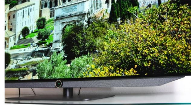
Die Ausgangsleistung der integrierten Soundbar beträgt satte zweimal 20 Watt.
