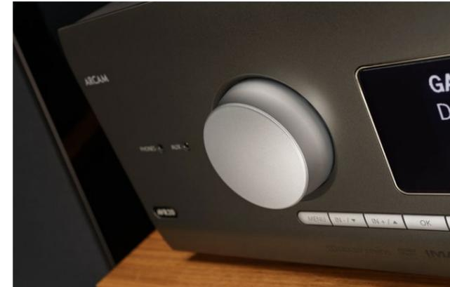
Der große Drehregler an der Front dient einzig dem Einstellen der Lautstärke. Für die Navigation durch die Menüs werden Tastenfeld oder Fernbedienung verwendet.
