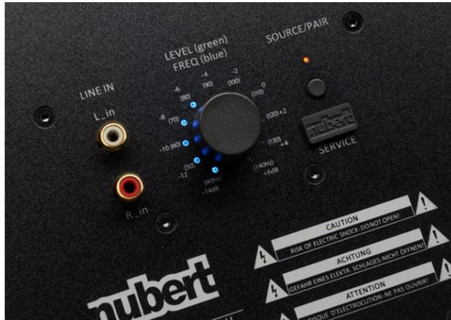
Das Kombiinstrument für die Anpassung von Pegel und Grenzfrequenz ist ausgezeichnet ablesbar und erleichtert die Bedienung des XW-1200. Die Farbe der LEDs und ihre Anzahl, geben dabei Rückschluss auf die eingestellten Werte.
