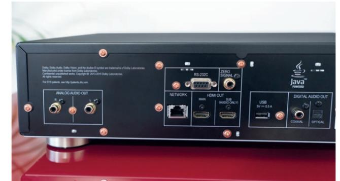
Das Anschlussfeld des UDP-LX500 ist großzügig dimensioniert und üppig ausgestattet.
