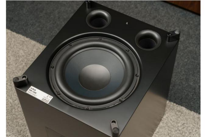
Mit zwölfteinhalb Zoll Durchmesser legt Nubert, im Vergleich mit den meisten anderen Subwoofern auf dem Markt, noch mal ein paar Millimeter drauf. Dazu wird das Chassis von den beiden Bassreflexöffnungen an der Vorderkante unterstützt.
