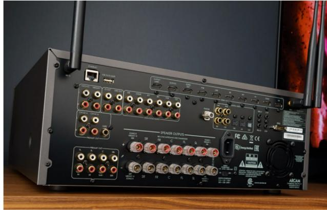
Bis zu 16 unterschiedliche Kanäle von zahlreichen Quellen kann der AVR20 verarbeiten. Der interne Class-AB-Verstärker stellt Lautsprechern dabei bis zu 190 Watt zur Verfügung.
