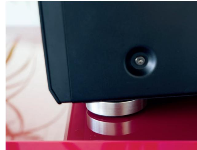
Die massiven Füße sorgen für einen stabilen Stand und helfen Übertragungen von außen auf ein Minimum zu reduzieren.
