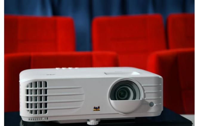
Der ViewSonic PX701-4K ist ein günstiger Ein-Chip-DLP-Projektor mit 4K/XPR-Technologie, der in Wohnzimmer und Heimkino überzeugt. Er wird überkopf an der Decke installiert oder auf einem Tisch vor der Leinwand aufgestellt - dank seines durchdachten Offsets funktioniert beides.
