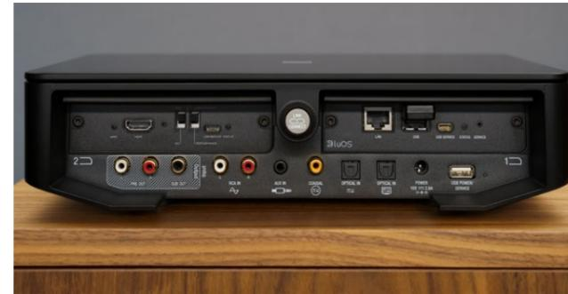
Mit der silbernen Connect Taste, lassen sich Sound Hub und die verschiedenen Aktivlautsprecher verbinden. Links und rechts neben der Tasten befinden sich die beiden Modulsteckplätze, mit denen die Funktionalität des Hubs erweitert werden kann.
