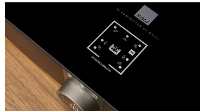
Die Displays auf Sound Hub und den einzelnen Lautsprechern, geben bei der Einrichtung Aufschluss über die Kanalzuteilung des Systems. Dank des leicht verständlichen Schemas, ist diese in wenigen Momenten erledigt.
